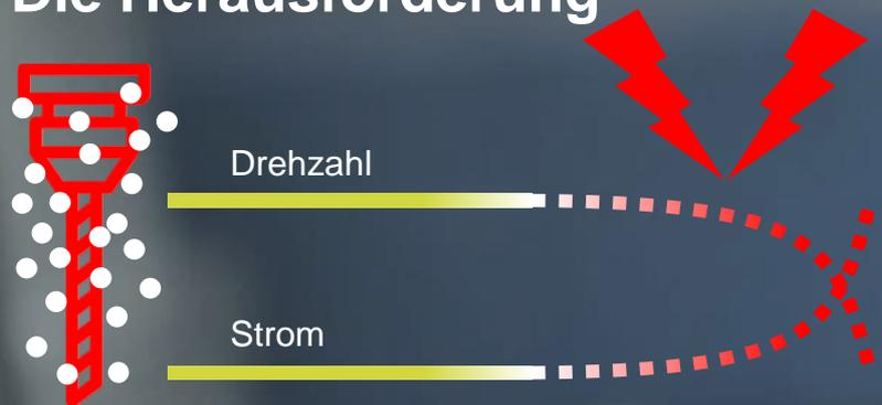
Aggressiver Frässtaub verursacht einen Ausfall des Antriebslagers der Frässpindel
