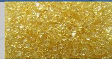
→ Basispolymere thermoplastischer Schmelzklebstoffe zum Beschichten / Kaschieren technischer Textilien.
