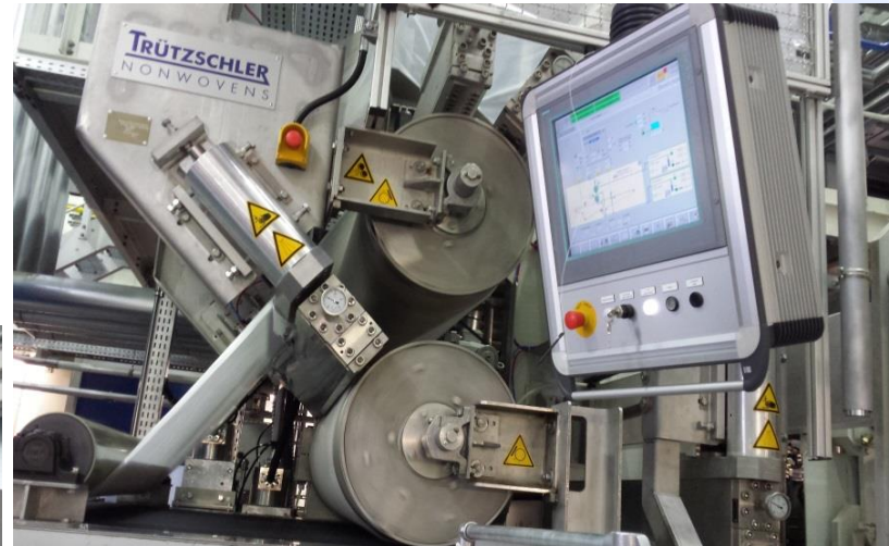
Aquajet-Anlage zur Wasserstrahlverfestigung
