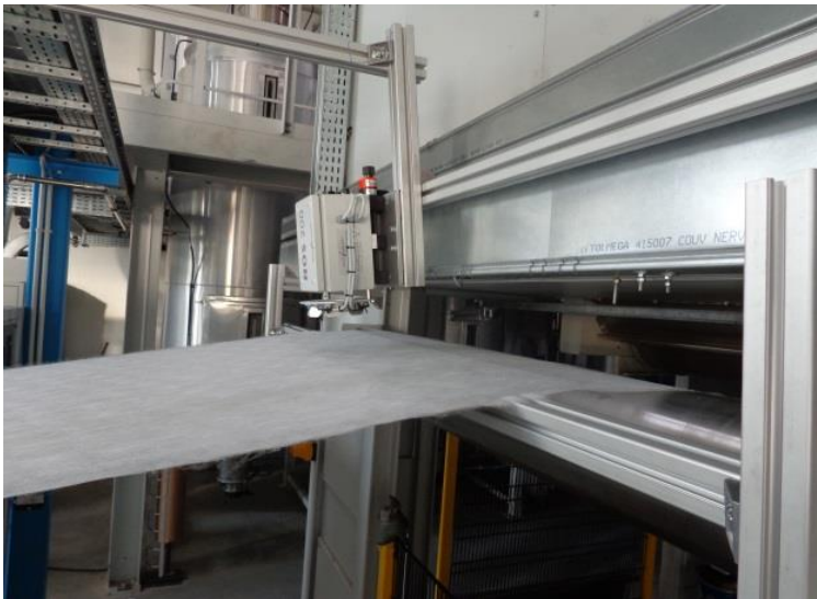
Anordnung der Kamera nach dem Siebtrommeltrockner
