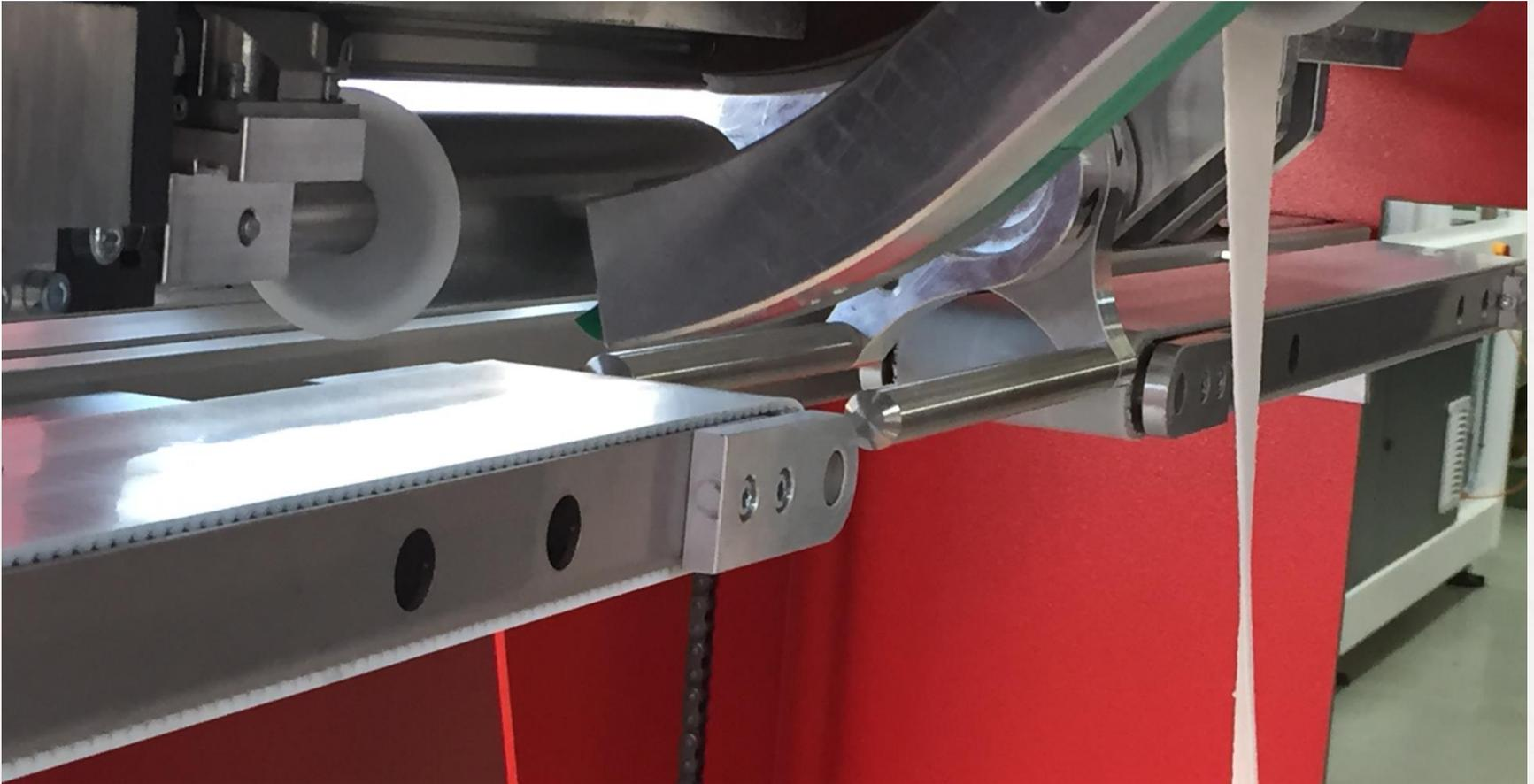
Die angetriebenen Niederhalter zum Andrücken der Materialschlaufen
