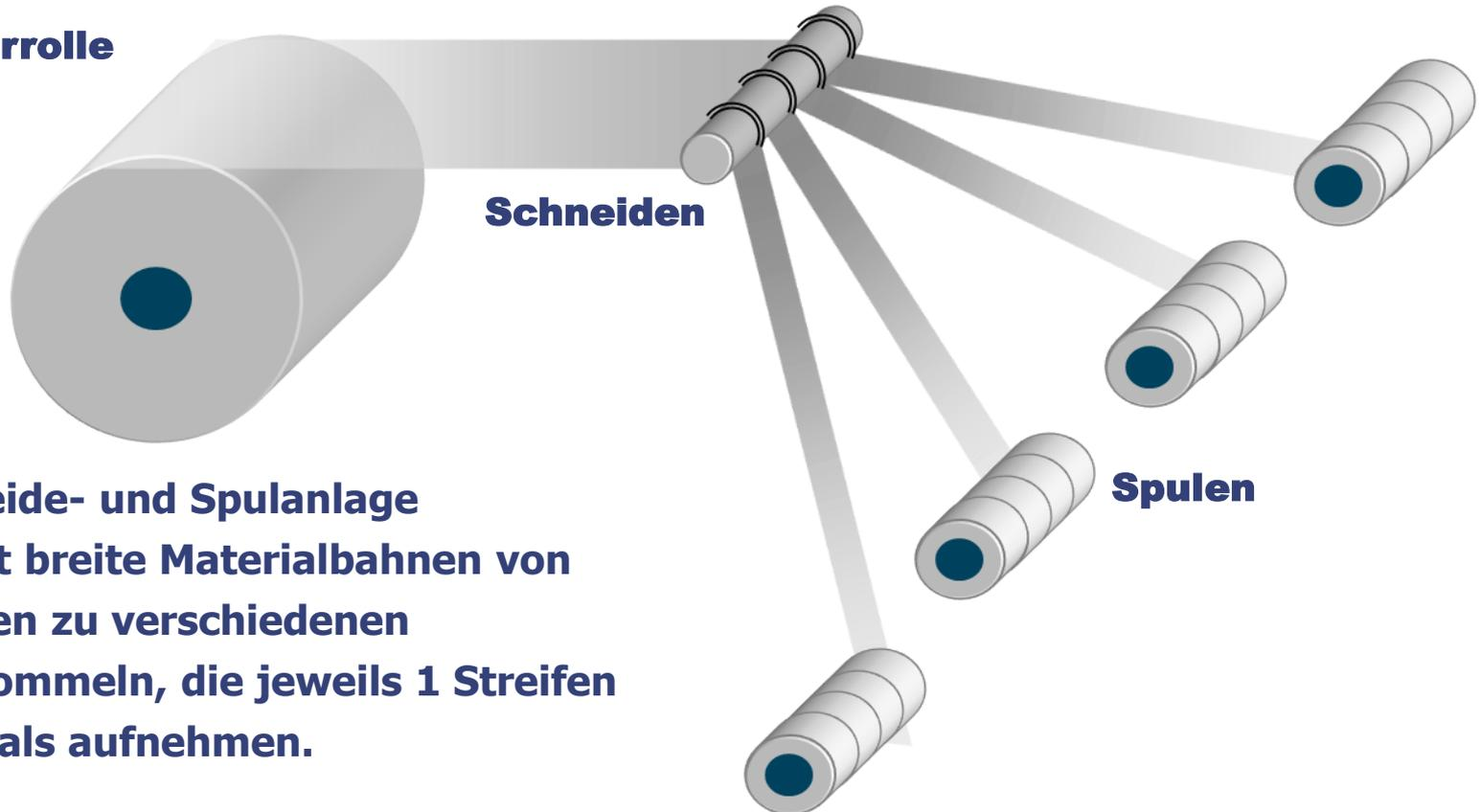
Eine Schneide- und Spulanlage konvertiert breite Materialbahnen von Mutterrollen zu verschiedenen Spulen/Trommeln, die jeweils 1 Streifen des Materials aufnehmen.
