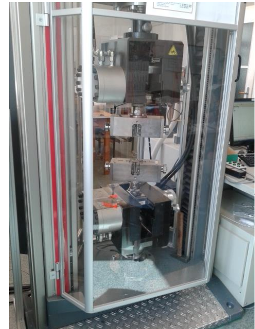
Zugprüfung durch Zwick Z100
