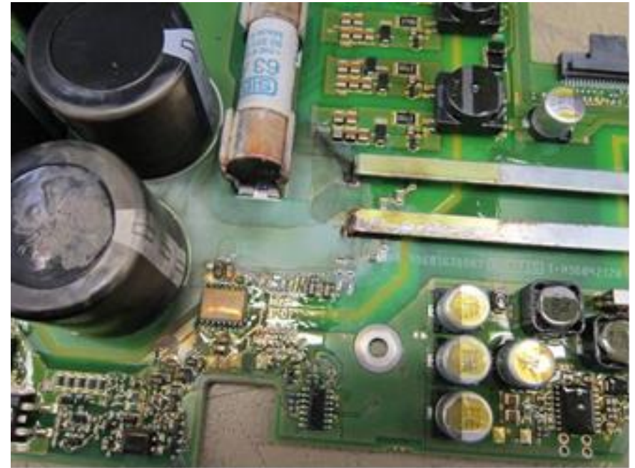
Detailvergrößerung Überschlagsspuren auf dem Power-Board
