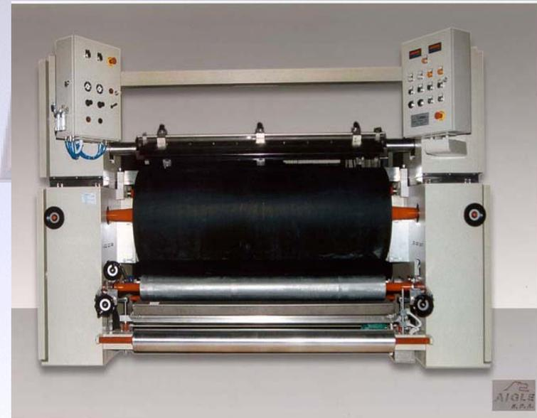
**Beschichtungskopf mit Messer-Rakel und Walzen-System**
