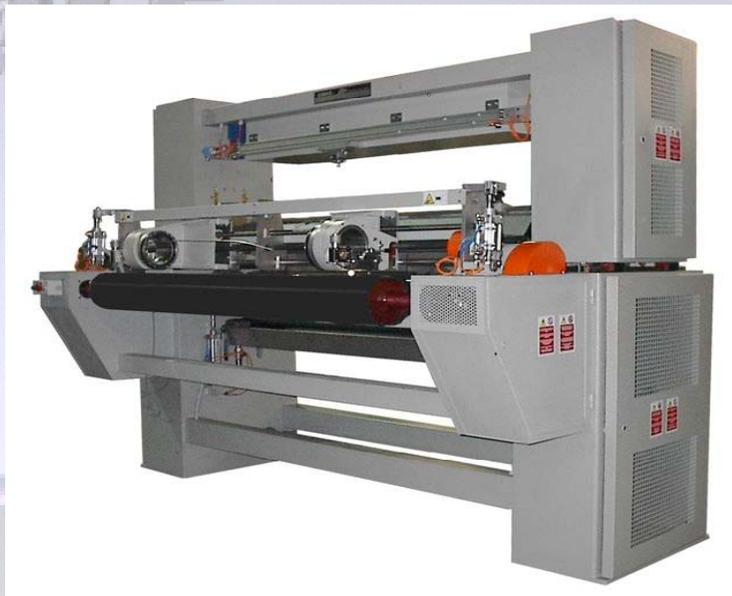
**Beschichtungskopf mit Messer-Rakel und Rotations-Sieb**
