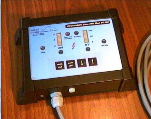
Elektrostatischer Generator mit stabilisierter Spannungsabgabe
