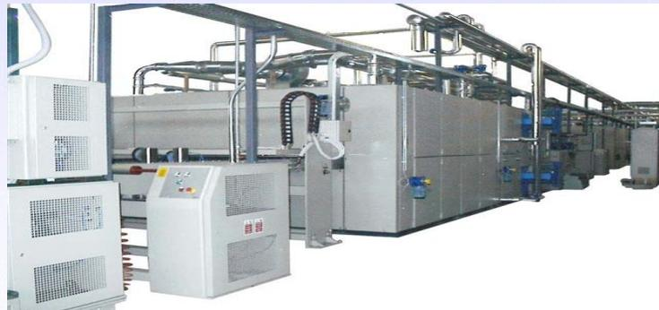
**Beschichtungs-Anlage für Rücken-Beschichtung bis zu 5,3 Meter Arbeitsbreite**
