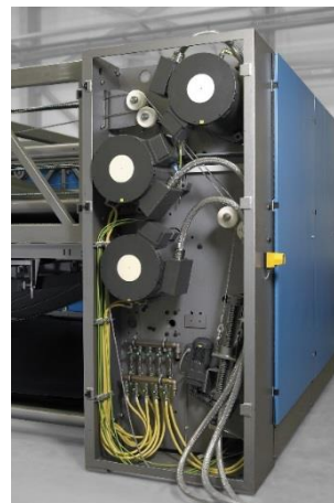
Wassergekühlte Torque-Motoren ohne Zahnradstufen
