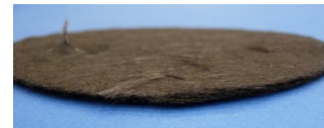
C-Faser Vliesstoff (Dicke = 4 mm)
