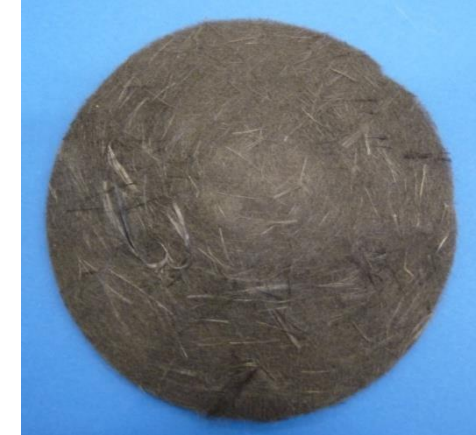
C-Faser Vliesstoff (Fläche = 100 cm 2 , Flächengewicht = 100 g/m 2 )
