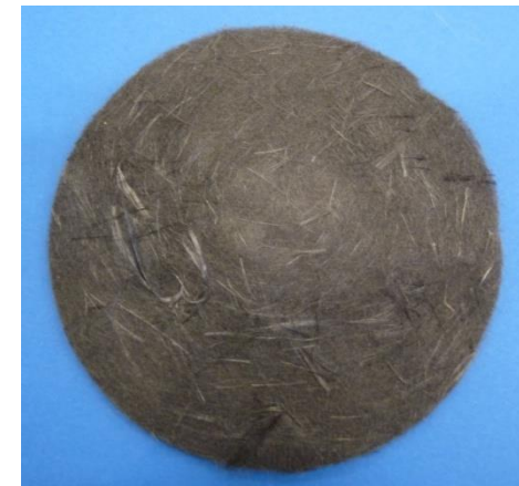
C-Faser Vliesstoff (Fläche = 100 cm 2 , Flächengewicht = 100 g/m 2 )
