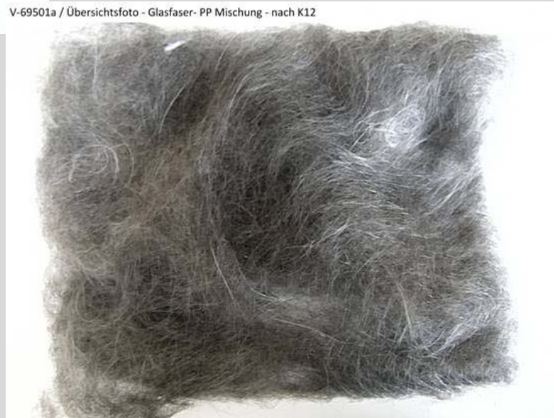
V-69501a / Übersichtsfoto - Glasfaser- PP Mischung - nach K12
