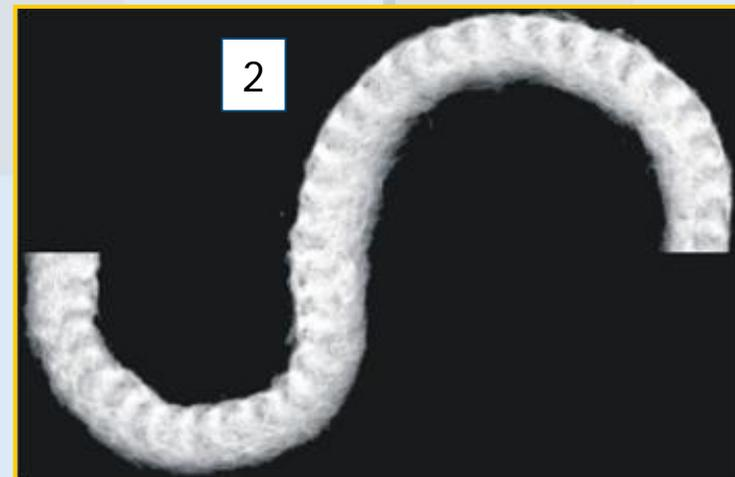
Thermokalibrierung und Strukturfixierung unter Verwendung von 6–9 % Schmelzklebefasern oder 12–18 % Bikomponentenfasern
