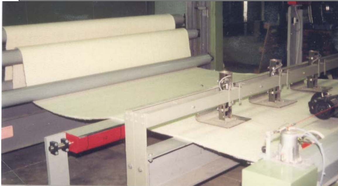
Multisegment Metalldetektor METRON 04 Profi Line zur Untersuchung von Warenbahnen
